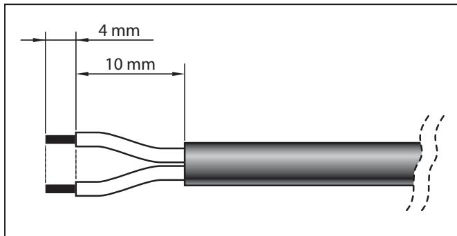
Quindi, procedere ad assemblare la presa “a pipetta” in **colore NERO** all'estremità del cavo di alimentazione, nel modo seguente:
