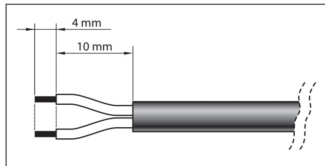
Quindi, procedere ad assemblare la presa "a pipetta" in **colore GRIGIO** all'estremità del cavo del pannello, nel modo seguente:
