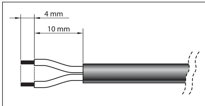
Dann zum Zusammenbau der **SCHWARZEN** “Pipetten”-Steckerbuchse am Ende des Speisekabels wie folgt übergehen:
