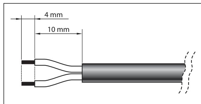
Posteriormente, ensamble la toma en “L” de **color GRIS** en el extremo del cable del panel, de la siguiente manera:
