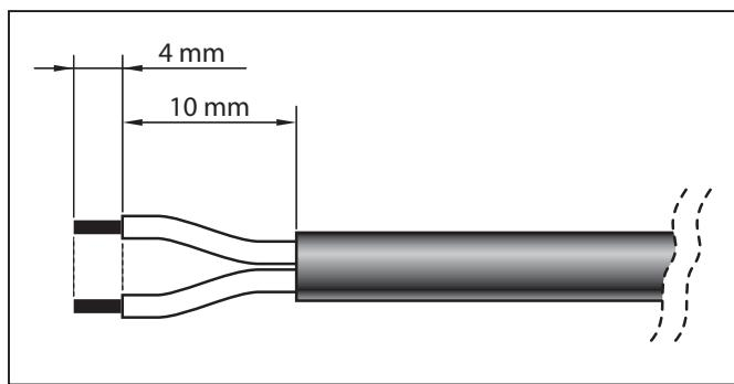
Posteriormente, ensamble la toma en “L” de **color NEGRO** en el extremo del cable de alimentación, de la siguiente manera:
