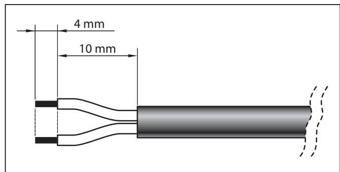
Dann zum Zusammenbau der **grauen** „Pipetten“-Steckerbuchse am Ende des Kabels des Kollektors wie folgt übergehen:
