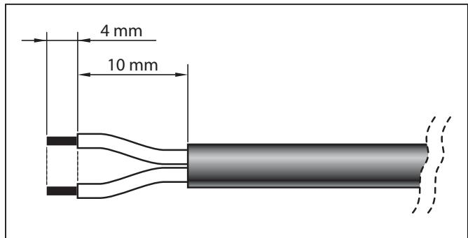
Ga daarna als volgt te werk om de **ZWARTE** “pipet” aansluiting op het uiteinde van de voedingskabel te monteren:
