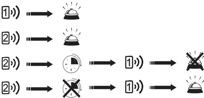
Option 3 « détection enchaînée bidirectionnelle » : l'activation du 1er détecteur, suivi de l'activation du 2nd détecteur pendant le laps de temps programmé déclenche l'alarme. L'activation du 2nd détecteur, suivi de l'activation du 1er pendant le laps de temps programmé déclenche l'alarme.
