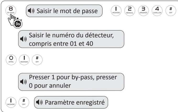
L'armement total ou partiel est possible, mais le détecteur ne déclenchera pas d'alarme en cas de détection.
