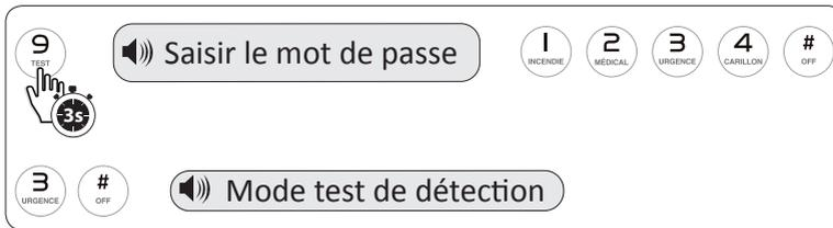
La centrale passe en mode test. Tester les détecteurs en les déclenchant un par un. Pour les détecteurs d'ouverture simuler une ouverture, pour les détecteurs de présence simuler un mouvement. Chaque déclenchement d'un détecteur affiche le numéro du détecteur en alerte et fait sonner l'alarme pendant environ une seconde.
