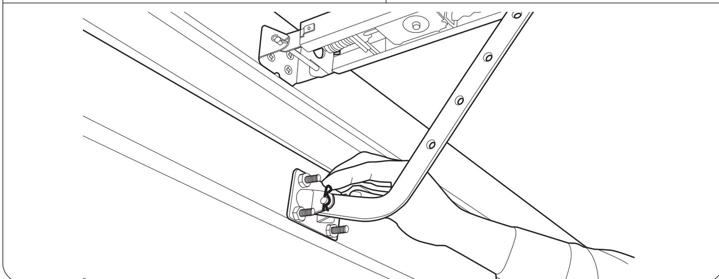
→ Si la patte coudée est trop courte pour être assemblée avec la patte de fixation porte, la rallonger avec la patte droite. Ne rallonger que du minimum nécessaire.
