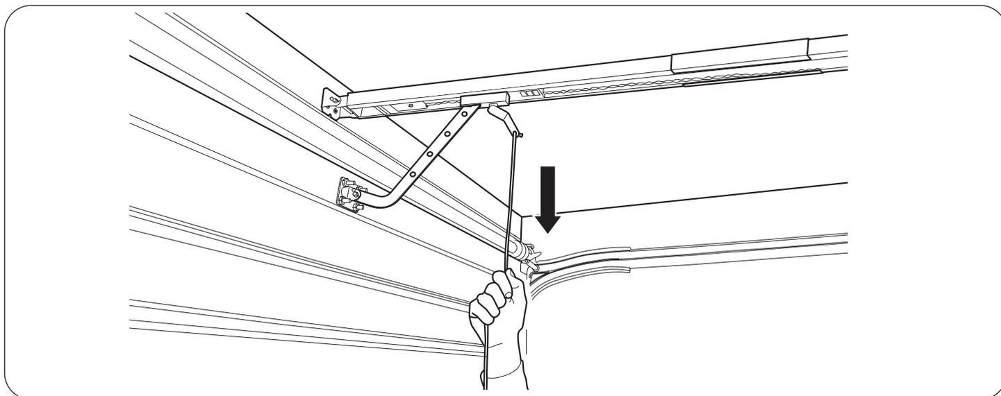
→ Vérifier manuellement que la porte s'ouvre et se ferme complètement et correctement.
