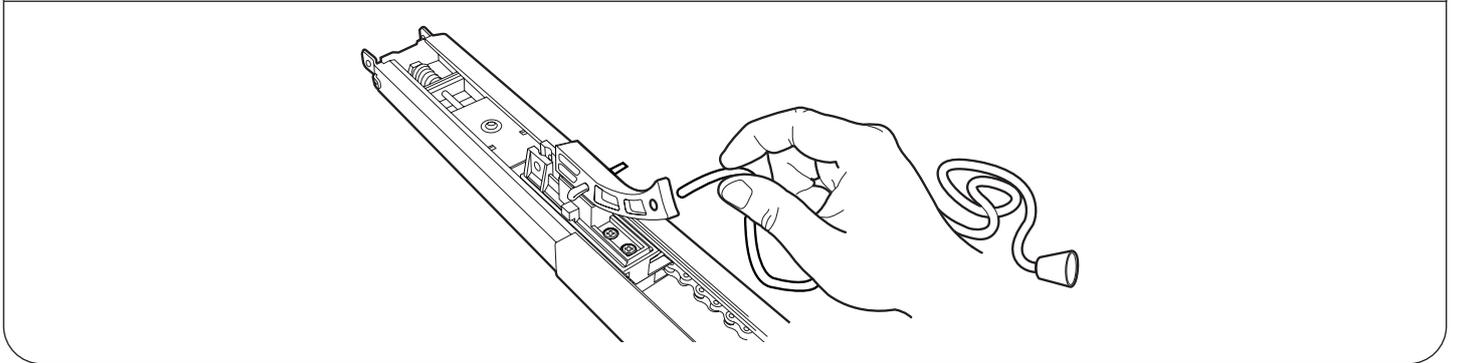
→ Fixer la patte coudée au chariot du rail à l'aide de l'axe de fixation et de la goupille.
