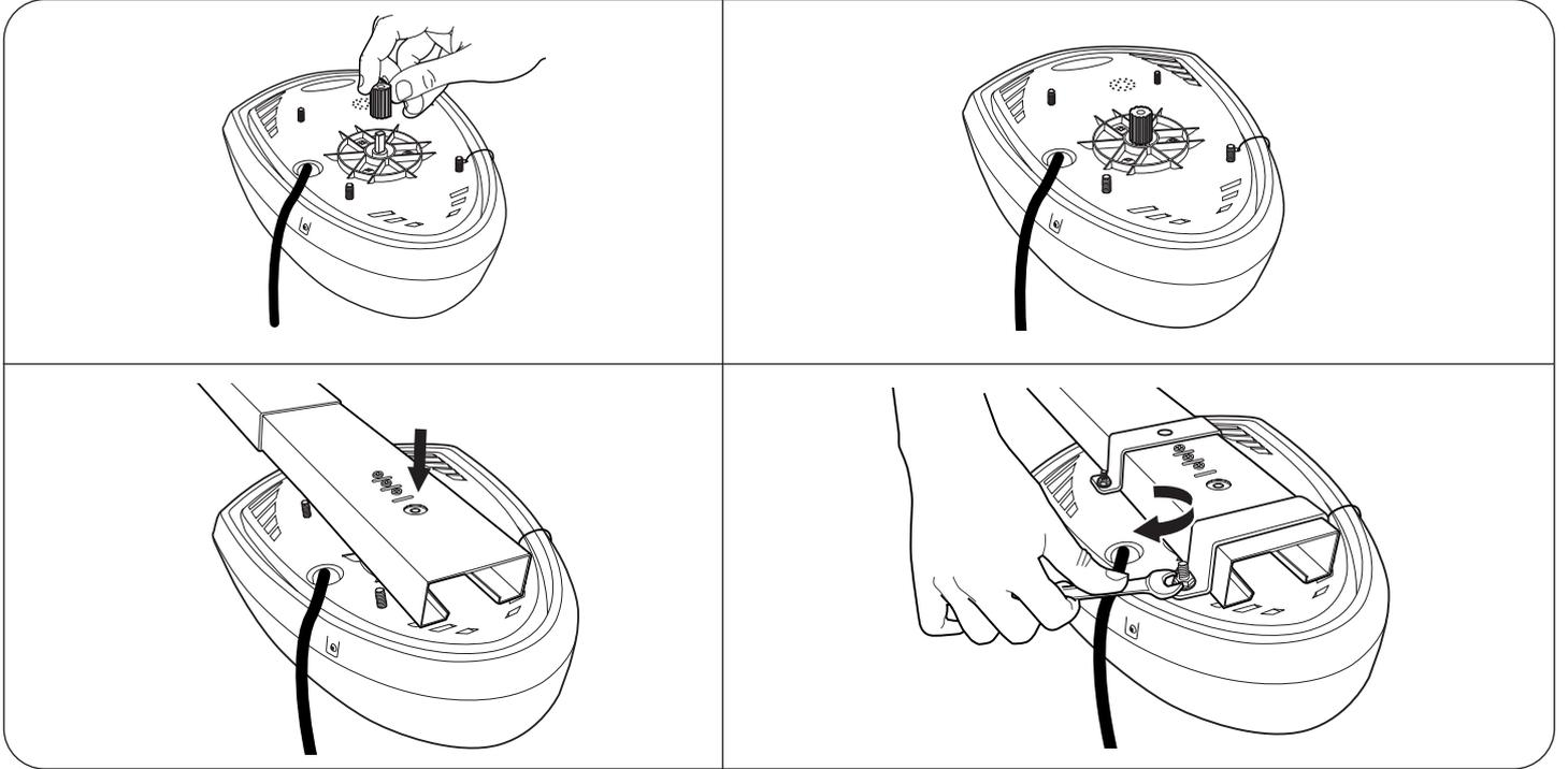
→ Tendre la chaîne et positionner le chariot moteur en face de la pièce noir d'embrayage.
