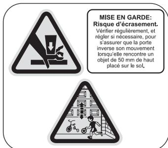
➔ Après installation, s'assurer que le mécanisme est correctement réglé et que la motorisation change de sens lorsque la porte rencontre un objet de 50 mm de hauteur placé sur le sol (pour les motorisations comportant un système de protection contre l'écrasement qui dépend du contact avec le bord inférieur de la porte).
