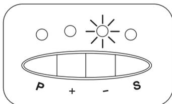
➔ Appuyer sur les boutons «+» et «-» pour ajuster le niveau de puissance pour la fermeture de la porte.
