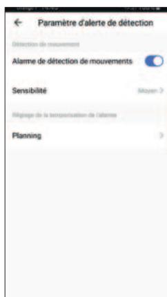
Il est possible d'activer la détection de mouvement en permanence ou définir une plage horaire d'activation. Il est également possible de régler la sensibilité de détection en faible, moyenne ou élevée.
