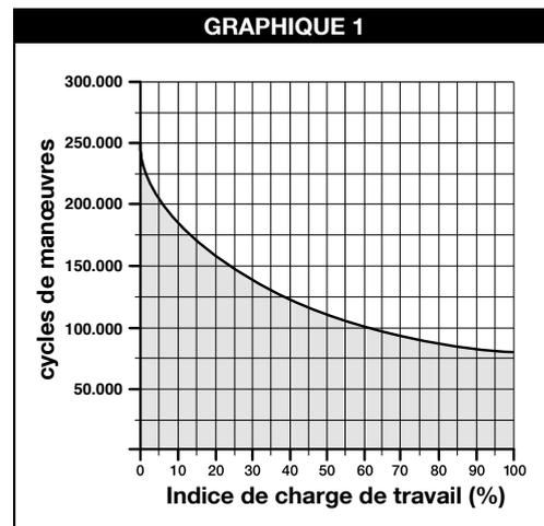
Les valeurs de durabilité indiquées dans le graphique ne s'obtiennent que si le plan de maintenance est rigoureusement respecté (chapitre 7). L'estimation de durabilité est effectuée sur la base des calculs de projet et des résultats d'essais effectués sur les prototypes. En effet, s'agissant d'une estimation, elle ne représente aucune garantie sur la durée effective du produit.
