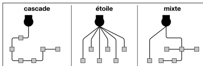
**02.** Observer la **fig. 3** pour comprendre comment positionner les câbles électriques dans l'environnement (nous conseillons de dessiner sur papier un schéma similaire, en l'adaptant aux besoins).
