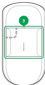
3 - Panneau de fixation SmartBracket (la découpe est nécessaire pour faire fonctionner le Tamper en cas de tentative d'arrachage du détecteur depuis la surface)
